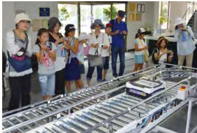
▲パワーモラ（伊東電機が開発）を使用したローラーコンベヤ。
