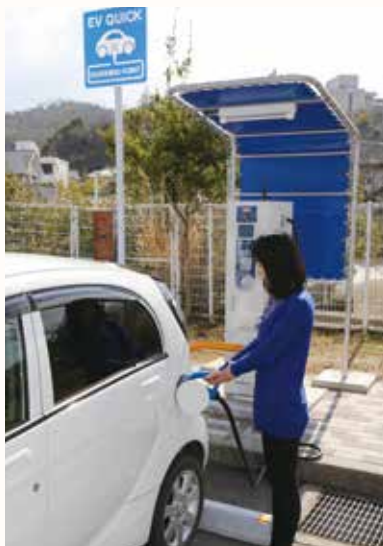
▲電気自動車に充電コネクタを差し込み、スタートボタンを押すだけで充電できます。30分間で約50kmの走行が可能。
