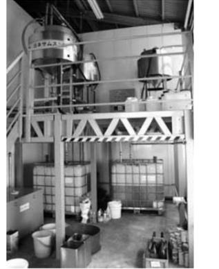
北条町駅車庫内で稼働する廃食用油リサイクルセンターの BDF 製造装置
