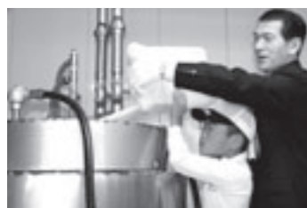
回収された廃食用油を精製タンクへバイオディーゼル燃料を製造
