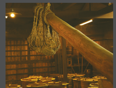
木製天秤搾り機。古来の製法でも醤油づくりに取り組んでいる
