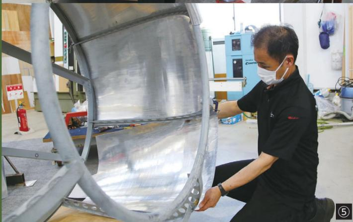
①完成に向けて作業を進める②写真を見ながらイメージ③ハンマーでアルミ板をたたき丸みを付ける④イングリッシュホイールで成形する⑤成形したアルミ板をエンジン部分に貼り付ける
